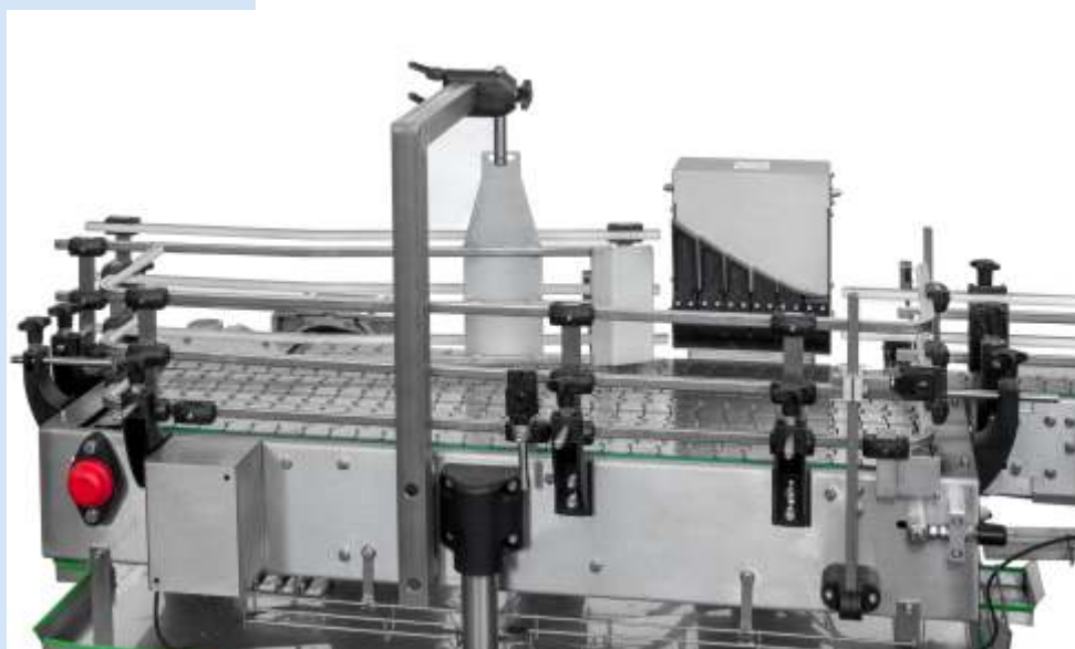
Espulsore multipush e nastri raccolta scarto Multipush ejector and waste collection conveyors Système d'éjection « multi-push » des bouteilles non conformes
