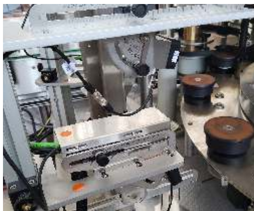
Sistema di orientamento bottiglie con telecamera Bottle orientation system with camera Système d'orientation des bouteilles avec caméra Sistema de orientación de botellas con cámara Flaschenorientierungssystem mit Kamera
