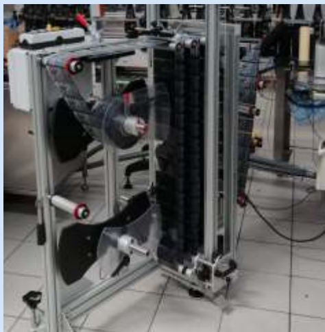
Gruppo di alimentazione etichette motorizzato a doppia bobina Motorized label unwinder for dual jumbo rolls Unités d'alimentation des étiquettes motorisées à bobine double Portabobinas motorizadas dobles Motorisierten Abwickler für grobe Etikettenspulen
